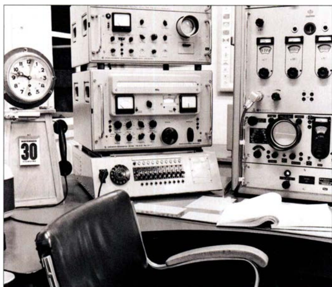
Funkarbeitsplatz mit Rohde & Schwarz EK07 (Bildmitte), Einseitenband- Demodulator NZ 10/2 (oben) und Einwahl-einrichtung in das Telefonnetz (unten). Rechts im Bild (von unten nach oben) Schomandl Netzteil UG1, Oszilloskop und Frequenzdekade Schomandl ND 5; der eigentliche Sender ist nicht im Bild.
