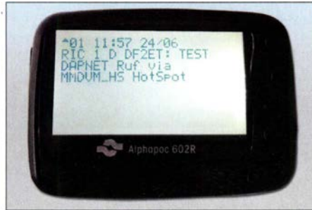
Testaussendung eines HotSpot MMDVM_HS über das DAPNET, hier von einem POCSAG-Meldeempfänger empfangen und angezeigt
