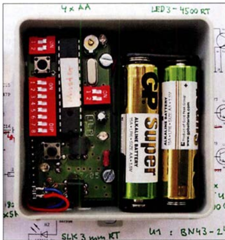
Bild 4: Fuchsjagdsender auf 3,5795 MHz in einer Abzweigdose Foto: DL2AVH
