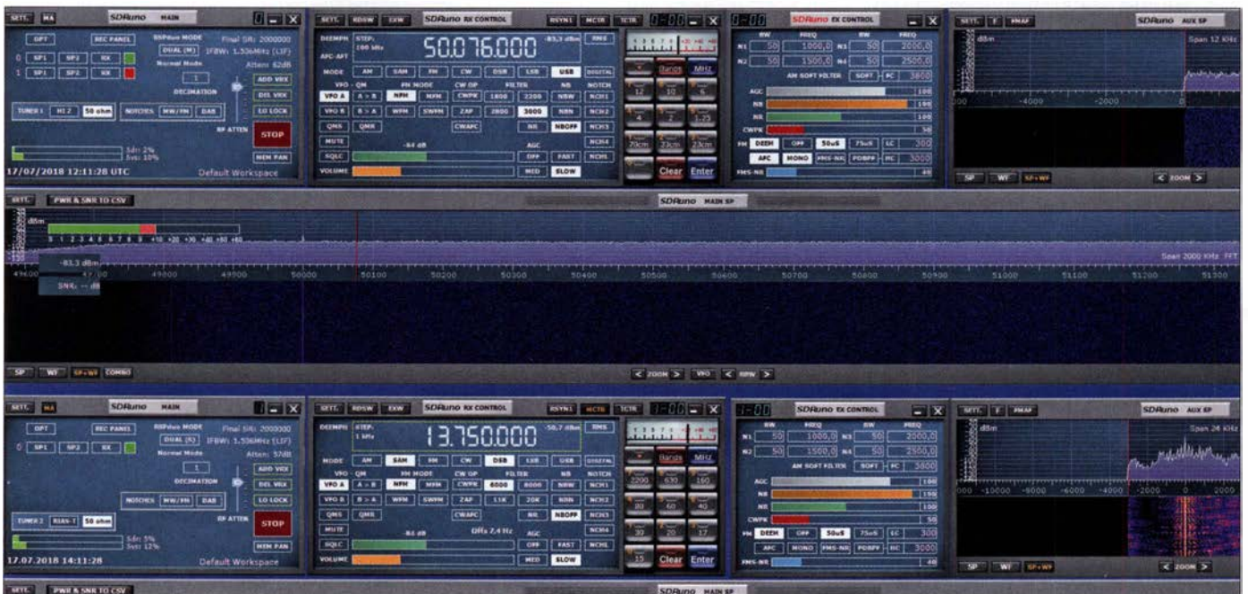
Bild 4: Zwei Tuner im Einsatz: Die oberen Fenster zeigen Tuner 1 bei der Überwachung des 6-m-Bandes, die unteren Tuner 2 auf der Frequenz von Radio Romania International.
