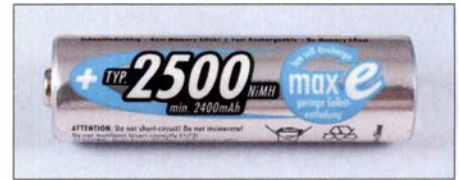
Bild 22: Diese NiMH-Zelle mit denselben Abmessungen wie die in Bild 21 kann die fünf-fache Energiemenge speichern.
