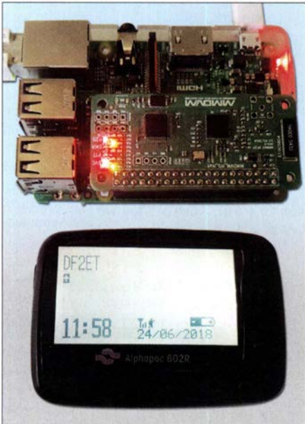
HotSpot MMDVM_HS als Aufsteckplatine für den Raspberry Pi Zero im Zusammenwirken mit einem Pager Fotos: DF2ET
