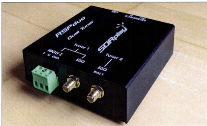
Bild 1: RSPduo im Metallgehäuse; zwei SMA-Anschlüsse und ein hochohmiger Schraubanschluss dienen der Verbindung mit geeigneten Antennen.
