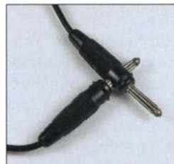
Bild 16: Diese Art der Verbindung von Bananensteckern birgt das Risiko von Kurzschlüssen.
