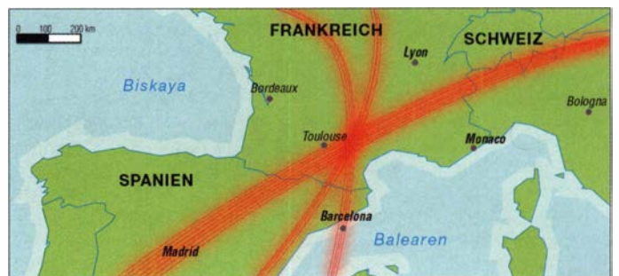
Bild 2: HF-Peilung eines STANAG4285- Datensignals auf 12666,5 kHz mit drei Hyperbeln: Im Schnittpunkt liegt der gesuchte Standort nahe bei Toulouse. Grafik: FA
