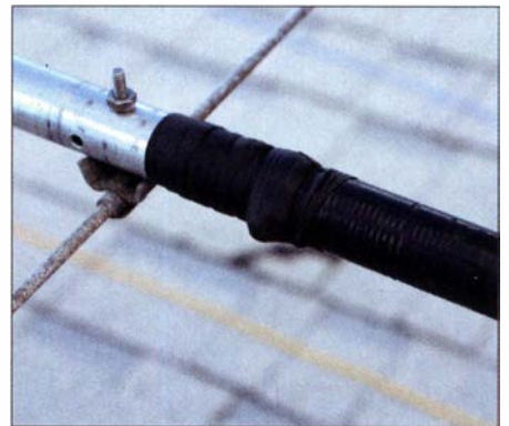
Reparierte Spule des 40-m-Beams
