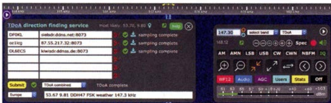
Bild 2: HF-Peilung eines STANAG4285- Datensignals auf 12666,5 kHz mit drei Hyperbeln: Im Schnittpunkt liegt der gesuchte Standort nahe bei Toulouse. Grafik: FA
