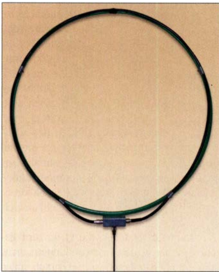
Bild 1: Ansicht der geschirmten Magnetic Loop; als Stützgerüst findet ein grüner Hula-Hoop-Reifen Verwendung. Der Außenschirm des Koaxialkabels ist oben auf 10 mm Breite unterbrochen.
